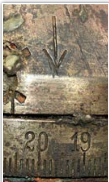
▽ FIGURE 111 Détail du réglage de la fusée.
