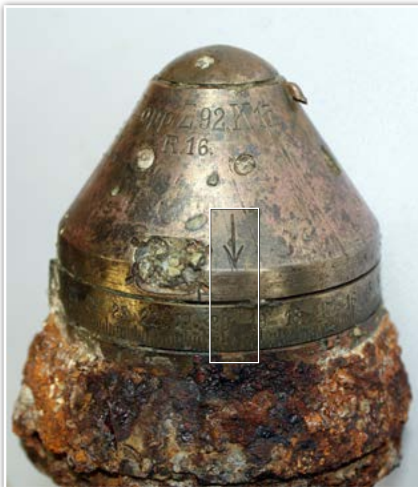
△ FIGURE 110 Fusée allemande Dopp Z92 montée sur un obus de 77 mm.
