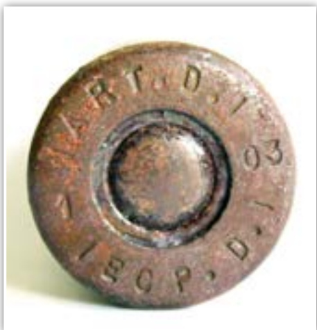
FIGURE II4 Culot de 8 mm Lebel présentant le marquage ART.D./1/ECP.D./03. Ce marquage peut se traduire par Direction de l'Artillerie, Désaleux, École Centrale de Pyrotechnie, 1903.
